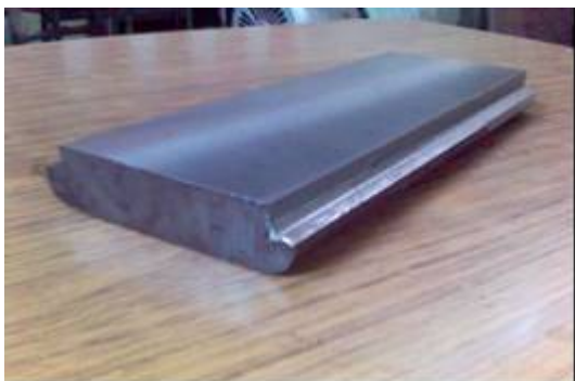
Fig. 2 : Eprouvette d'essai en Acier C18 Dimensions : (300x120x98).
