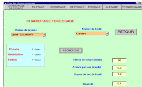
Figure 13. Aide au choix des paramètres de coupe dans le cas de CHARIOTAGE/ DRESSAGE
